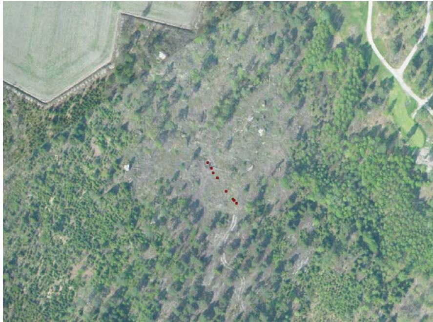
Figur 6. Exempel på inmätt profil för något kuperad mark. Profilen har en längd av 35 meter
